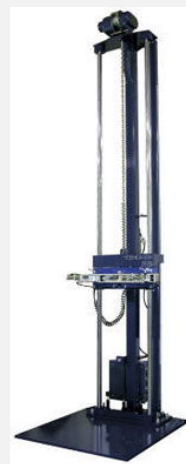
モバイル落下試験機 モデル:DT-205
